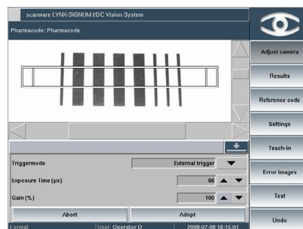
Die Fehleranalyse von Codes zeigt klar, welche Art von Abweichung vorliegt, sodass der Fehler behoben und der Auswurf minimiert werden kann.
